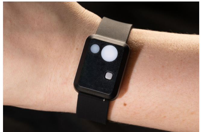
สายรัดข้อมือเพื่อรวบรวมข้อมูลทางสรีรวิทยาและพฤติกรรมแบบเรียลไทม์ของนักบินอวกาศในภารกิจ Artemis II (ที่มา: https://www.nasa.gov/image-detail/amf-jsc2025e075542_alt/ )
