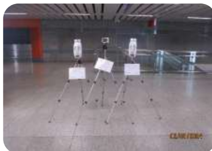
การตรวจวัดคุณภาพอากาศในสถานีรถไฟ
