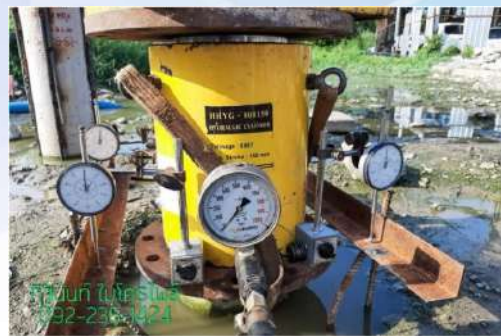
การทดสอบความแข็งแรงของเสาเข็มโดยใช้กระบอกลไฮดรอลิก
