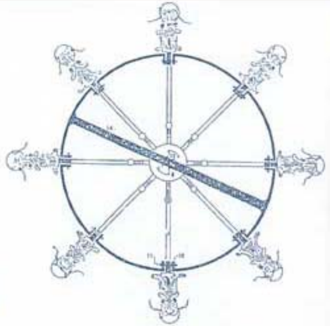
候风地动仪内部之机构横断面
