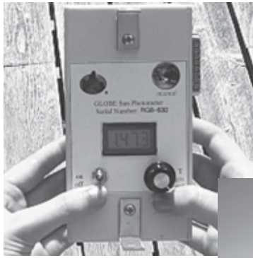
มาจาก : http://www.wmo.ch/pages/publications/meteoworld/archive/june08/images/CPT_2008_bd.jpg ภาพ Sun Photometer ซึ่งติดตั้งอยู่ที่สถานีตรวจวัดสภาพอากาศ ณ Cape Point ประเทศแอฟริกาใต้
