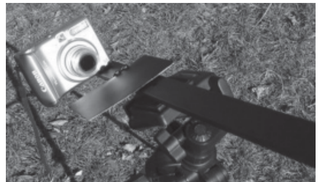
มาจาก : http://www.pages.drexel.edu/~brooksdr/DRB_web_page/Solar/AureolePhotography/Aureole.htm ภาพถ่ายตั้งกล้องสำหรับการถ่ายภาพรัศมีดวงอาทิตย์
