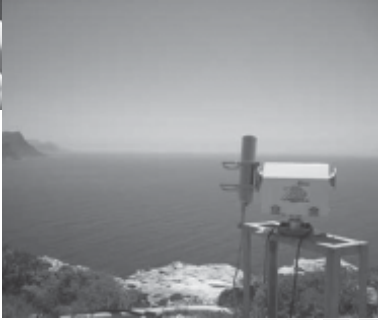
มาจาก : http://www.wmo.ch/pages/publications/meteoworld/archive/june08/images/CPT_2008_bd.jpg ภาพ Sun Photometer ซึ่งติดตั้งอยู่ที่สถานีตรวจวัดสภาพอากาศ ณ Cape Point ประเทศแอฟริกาใต้
