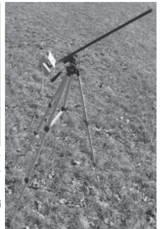
มาจาก : http://www.pages.drexel.edu/~brooksdr/DRB_web_page/Solar/AureolePhotography/Aureole.htm ภาพถ่ายตั้งกล้องสำหรับการถ่ายภาพรัศมีดวงอาทิตย์
