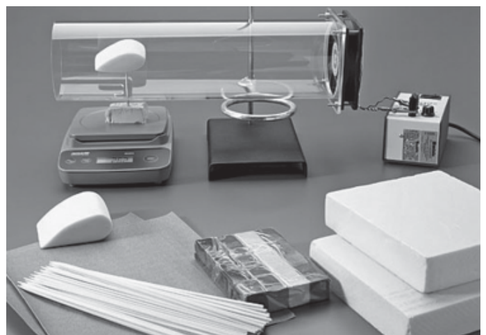
ภาพที่ 2 ชุดอุปกรณ์สร้างอุโมงค์ลมที่มีขายในท้องตลาด มีส่วนประกอบหลัก ได้แก่ พาวเวอร์ซัพพลายที่ทำหน้าที่จ่ายไฟให้กับพัดลมคอมพิวเตอร์ที่ถูกครอบด้วยท่อพลาสติกโปร่งใสใช้ทดลองกับวัตถุที่ทำจากโฟม ยึดด้วยไม้เสียบลูกชิ้นแล้วปักบนดินน้ำมัน ที่วางบนเครื่องซังดิจิทัล
